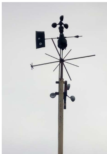
Čidla anemometru – přístroje, který nepřetržitě registruje směr a sílu větru
