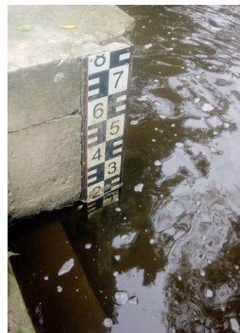
Součástí stanice je vodoměrná latě. V čase pořízení fotografie (23. 9. 2023) byla úroveň hladiny 122 cm
